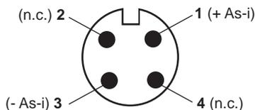
Conector adicional para o quarto detetor externo (S4), conector fêmea M12 x 5 polos
